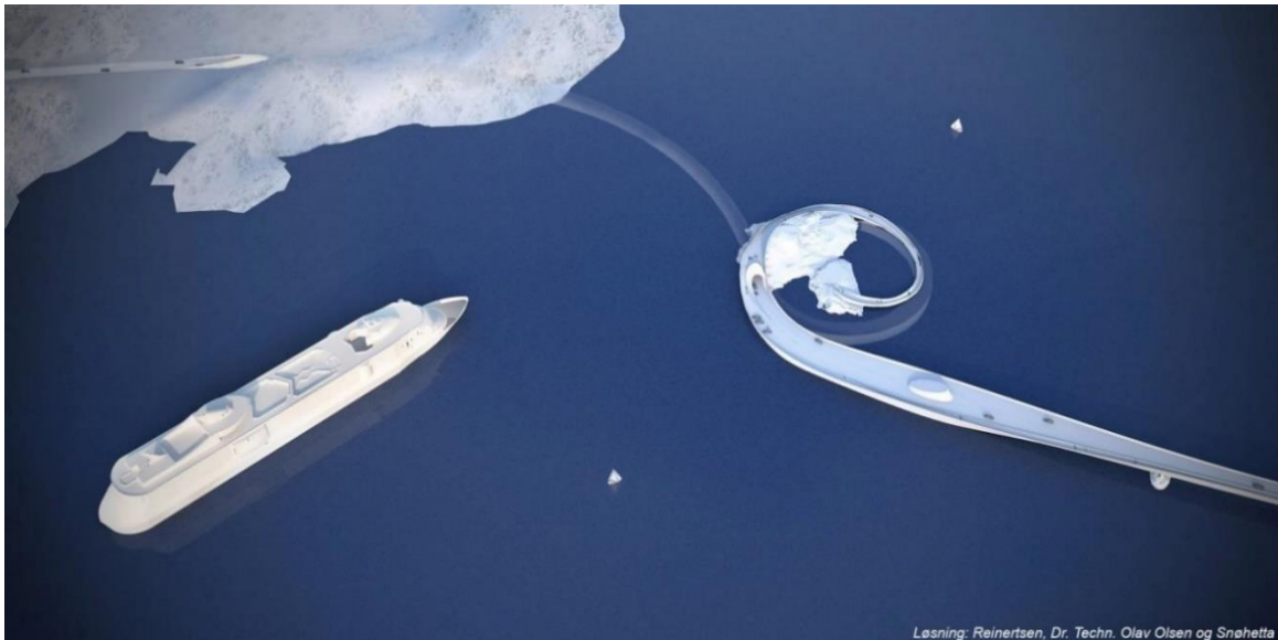
Figur 2: Illustrasjon av hvordan en eventuell flytebru med rørbru for fergepassasje kan se ut. Løsning laget av Reinersten, Dr. Techn. Olav Olsen og Snøhetta.
