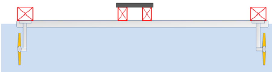
Figur 22: Konsept for å integrere tidevannsturbiner på flytebru
